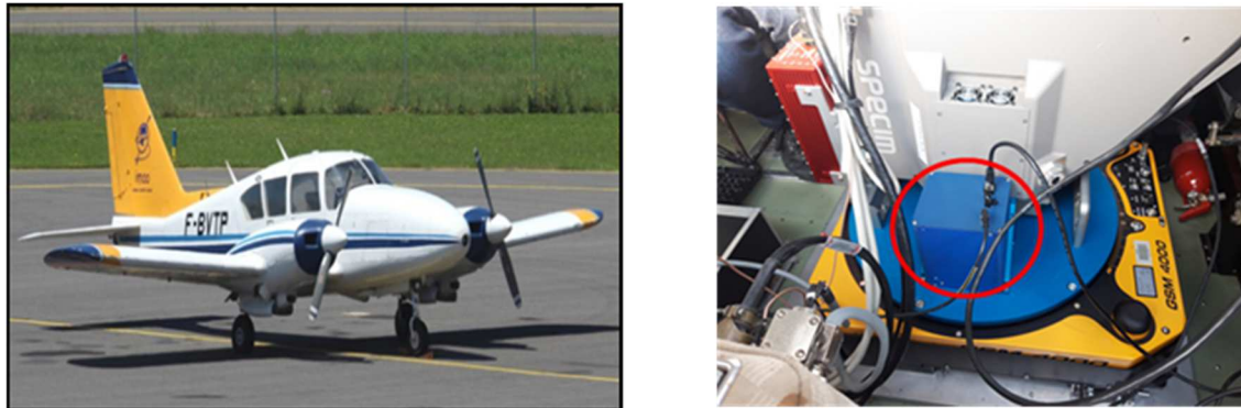
Figure 3 : Gauche : IMAO PA03, Droite : SIMAGAZ (en bleu entourée par un cercle rouge) intégrée sur la plateforme stabilisée au-dessus de la trappe photo.
