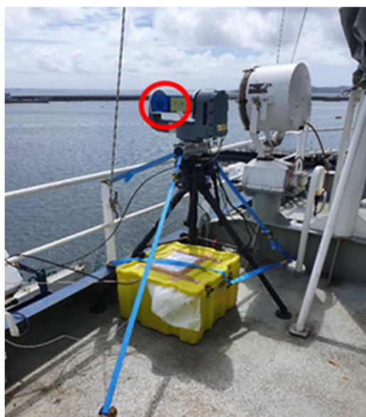
Figure 2: Instrument SIMAGAZ (en bleu entouré par un cercle rouge) disposé sur une plateforme stabilisée à bord du SAPEUR lors des essais en mer.
