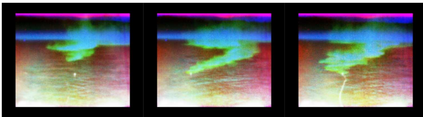
Figure 12 : Images en fausses couleurs issues des canaux SIMAGAZ pendant le déversement de N-butyl-acétate du SLOT2. De gauche à droite et de haut en bas, on observe avant le début du déversement puis 2 et 5 min (fin du déversement) après le début du déversement.
